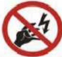
PROHIBIDO TOCAR RIESGO DE DESCARGA
